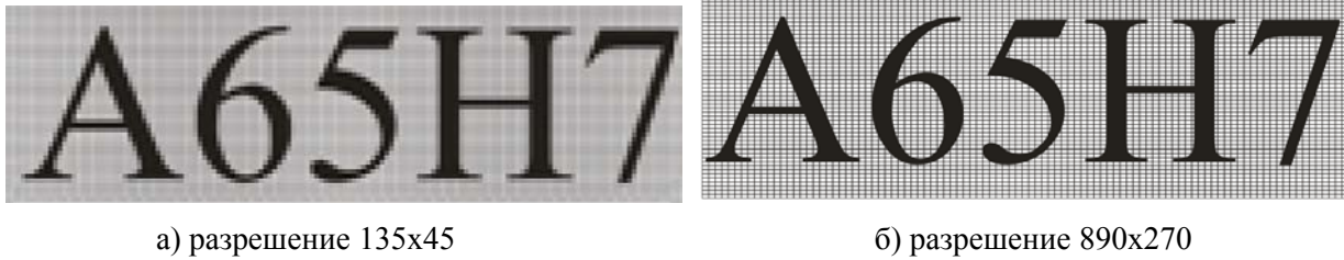
Рис. 5. Изображения текста: дискретизация выполнена при а) низком и б) высоком разрешении
