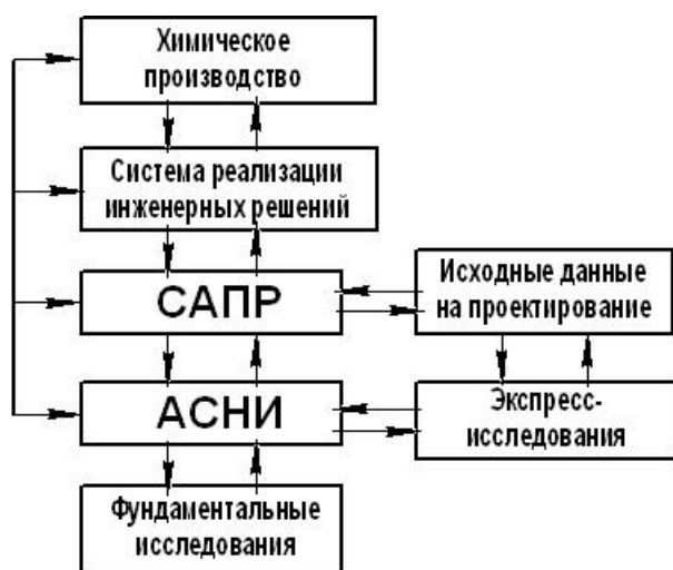
Рис. 4 – АСНИ в структуре проектирования химических производств [2]
